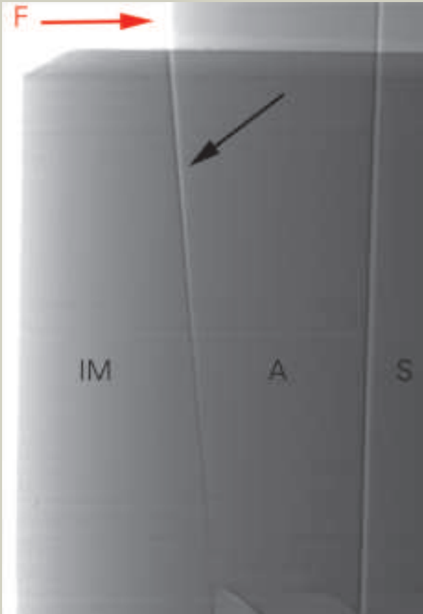
Mikrospalt. Synchrotron Röntgenaufnahme des Mikrospalts (schwarzer Pfeil) einer konischen Implantat-Abutment-Verbindung bei physiologischer Kaubelastung (roter Pfeil) im Rahmen einer In-vitro-Studie. IM = Implantat, A = Abutment, S = Abutmentschraube, F = Einwirkende Kraft (Abb. 3).
